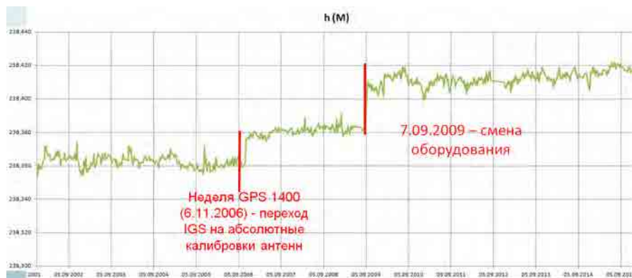
Рисунок 11 – График изменения высотной компоненты для пункта ФАГС Минск рабочий 1 за период времени с 2001 по 2015 гг.
